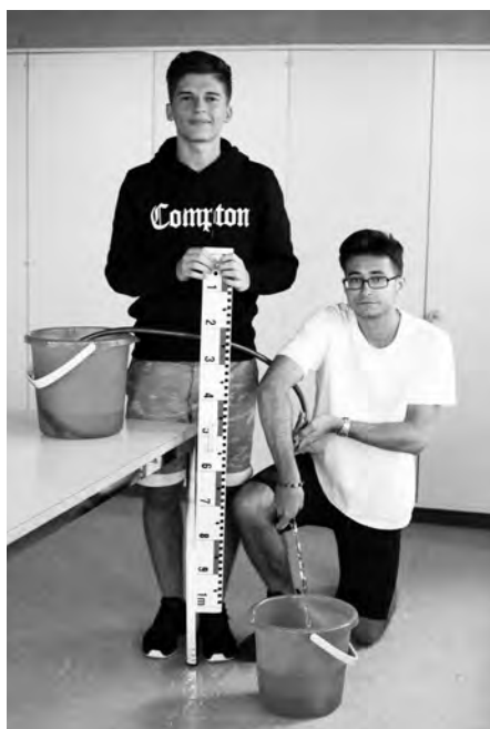
Wasser fliesst durch den Schlauch von selbst vom höher liegenden Eimer zum tiefer liegenden.
