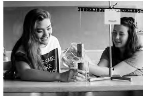
Empirischer Nachweis des Archimedischen Prinzips: Die Auftriebskraft eines Körpers in einer Flüssigkeit ist gleich gross wie die Gewichtskraft der vom Körper verdrängten Flüssigkeit.
